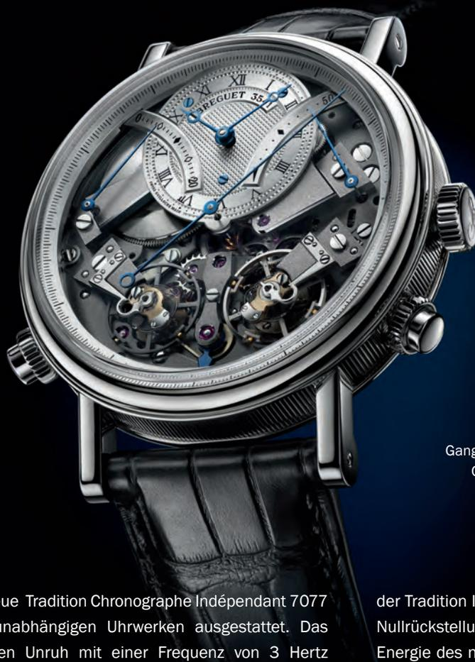
Breguet hat die neue Tradition Chronographe Indépendant 7077 mit zwei völlig unabhängigen Uhrwerken ausgestattet. Das Hauptwerk, dessen Unruh mit einer Frequenz von 3 Hertz schwingt, bietet eine Gangreserve von 50 Stunden und dient der Anzeige der Uhrzeit. Das zweite steuert den Stoppuhrmechanismus und ist mit einer rasanten Frequenz von 5 Hertz getaktet, um höchste Präzision beim Stoppen kurzer Zeitintervallen zu garantieren.
